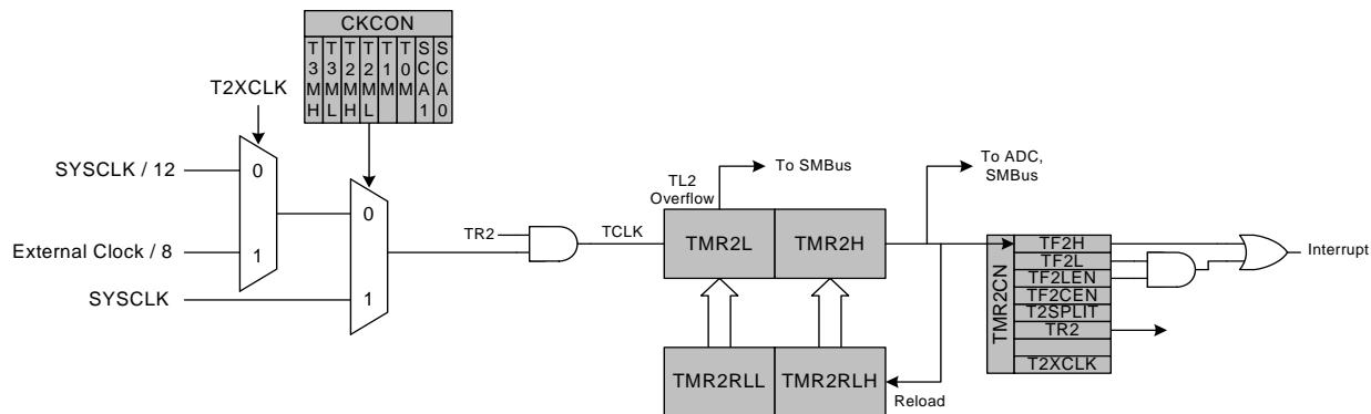
**Figure 18.4. Timer 2 16-Bit Mode Block Diagram**
