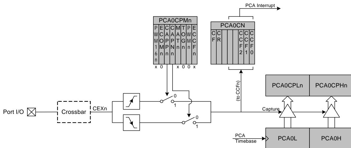
**Figure 19.4. PCA Capture Mode Diagram**
