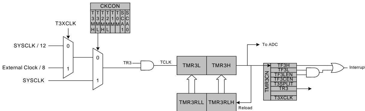
**Figure 18.6. Timer 3 16-Bit Mode Block Diagram**
