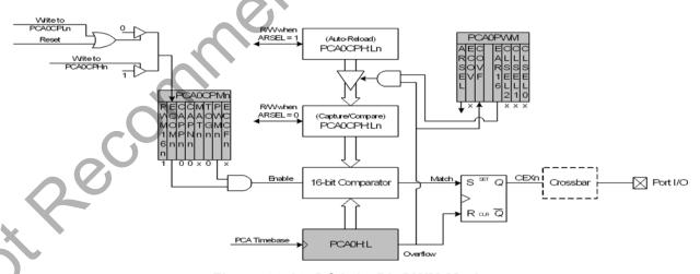
Figure 29.10. PCA 16-Bit PWM Mode
